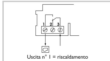
Se la caldaia ha un'entrata termostato sopprimere il deviatore che collega i 2 morsetti termostato e raccordare i morsetti 1 e 3 del cronotermostato.
