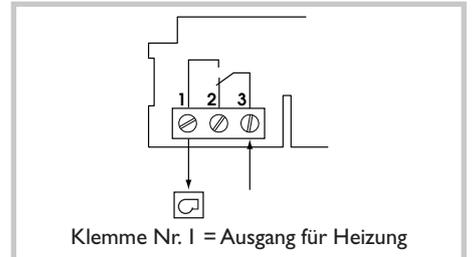
Sollte Ihre einen Thermostateingang besitzen, so entfernen Sie den Vorwiderstand zwischen den beiden Thermostateingängen und verbinden Sie die Klemmen 1 und 3 Ihres Uhrenthermostat mit den zwei Klemmen des Thermostateingangs der Heizung. Die Reihenfolge des Anschlusses ist nicht wichtig.
