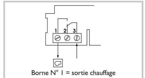
Si votre chaudière possède une entrée thermostat, supprimez le pontage reliant les 2 bornes thermostat et raccordez les bornes 1 et 3 de votre thermostat programmable aux 2 bornes d'entrée thermostat de la chaudière (le sens de raccordement est indifférent).
