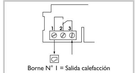
Si su caldera posee una entrada termostato, saque la resistencia entre los bornes para el termostato y conecte los bornes 1 y 3 de su termostato a los dos bornes de entrada termostato de la caldera (el sentido de la conexión es indiferente).
