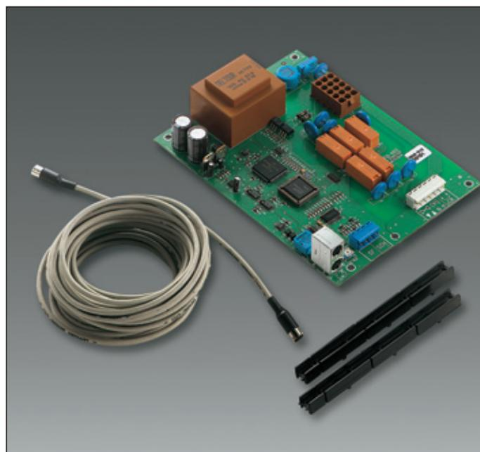
La platine "Cascade" se raccorde dans le tableau de commande K par un connecteur embrochable et sur le tableau DIEMAT-IC-m Delta et/ou un autre tableau K par l'intermédiaire du câble BUS.
