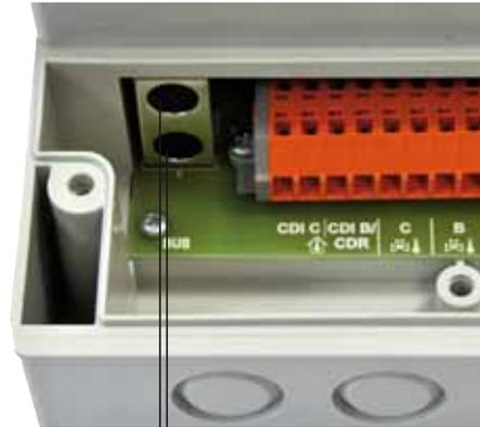
Le(s) câble(s) du BUS (colis AD 134, AD 124, DB 119) est (sont) à brancher sur l'une des 2 embases marquées BUS. La connexion se fait simplement par enfichage du connecteur mini-DIN du câble de liaison.
