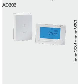
Ces thermostats assurent la régulation et la programmation du chauffage et de l'eau chaude sanitaire. Ils intègrent des paramètres de réglage pour la chaudière : pente de chauffe, température maxi chaudière, vitesse du ventilateur,... ainsi qu'une estimation de comptage d'énergie (nombre d'heures de fonctionnement de la pompe, ecs, totale,... conformément à la RE 2020). Le régulateur adapte la puissance chaudière aux besoins effectifs.
