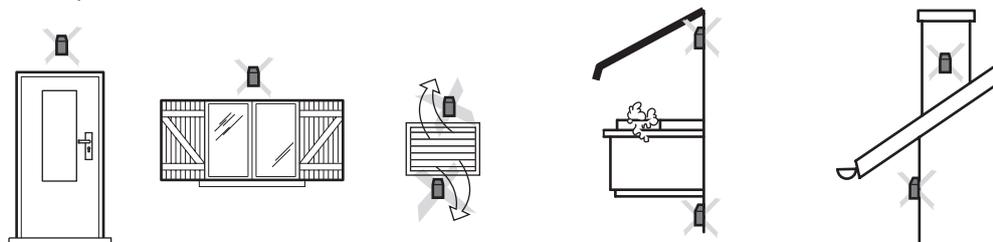
Fig.22 Montage de la sonde de température extérieure
