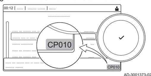
La plate-forme de commandes fait appel à un système avancé pour catégoriser les paramètres, les mesures et les compteurs. Une connaissance de la logique de ces codes facilite leur identification. Le code comprend deux lettres et trois chiffres.
