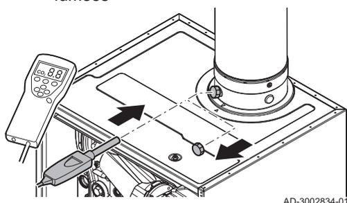
1. Déposer le bouchon du point de mesure des fumées.
