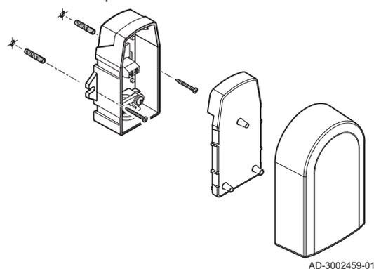
1. Percer deux trous de diamètre 6 mm.
