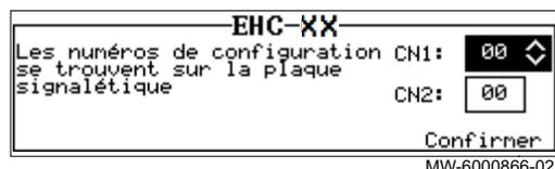
4. Régler les paramètres **CN1** et **CN2**. Les valeurs sont disponibles sur la plaquette signalétique du module intérieur. Elles sont également données dans le tableau ci-après.
