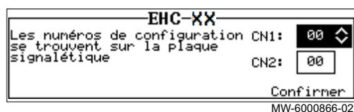
4. Régler les paramètres **CN1** et **CN2**. Les valeurs sont disponibles sur la plaquette signalétique du module intérieur. Elles sont également données dans le tableau ci-après.
