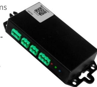
**Mise en Service:** on se sert d'un boîtier Mercurius comme outil de mise en service, le portail de maintenance n'affichera que les paramètres de réglage du boîtier connecté.
