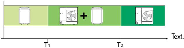
T1 : température extérieure minimale d'arrêt du compresseur de la PAC.
