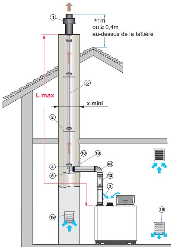
$$x \text{ mini } \begin{array}{l} \frac{\varnothing (\text{mm})}{\varnothing (\text{mm})} : D + 60 \\ \frac{\varnothing (\text{mm})}{\varnothing (\text{mm})} : D + 80 \end{array}$$
