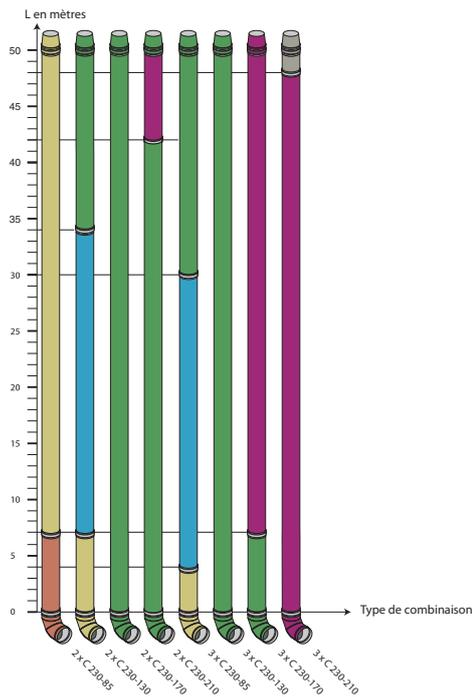
L max en fonction du Ø du conduit D pour différentes combinaisons « cascade » C 230
