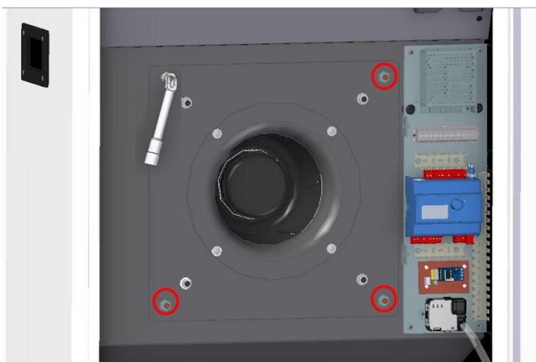
1. Suivre le schéma électrique et déconnecter les câbles d'alimentation et de commande du bornier. Avec une clé à pipe 13 mm retirer les 4 écrous de fixations du moteur.
