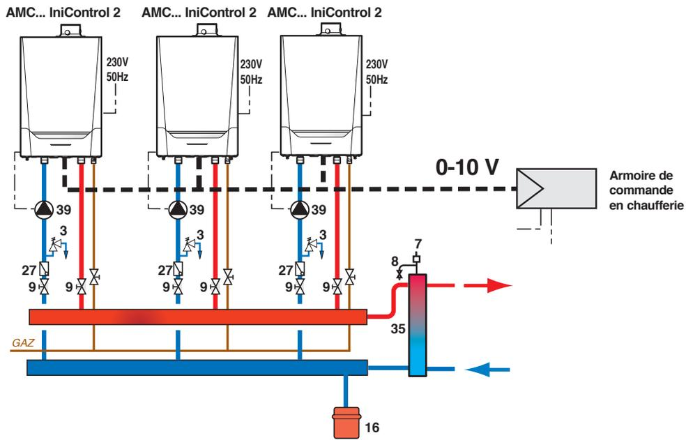
**REMARQUE:** Dans le cas d'une installation en cascade avec uniquement des chaudières AMC... Inicontrol 2, les câbles BUS et la sonde départ cascade livrés avec le système ne sont pas utilisés.
