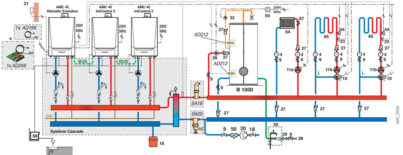
cas particulier d'une installation cascade avec plus de 2 circuits secondaires avec vanne mélangeuse: installation en cascade de 2 chaudières AMC PRO...DIEMATIC EVOLUTION avec 4 circuits avec vanne mélangeuse et un circuit avec des ventilo-convecteurs. L'ecs est produite par un préparateur d'ecs instantannée FWPC
