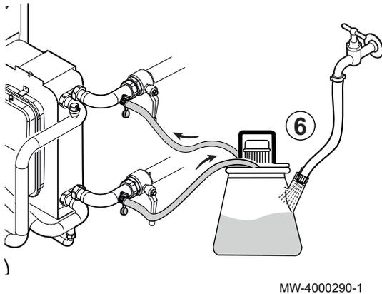
6. Rincer l'échangeur à plaques à l'eau jusqu'à l'obtention d'un pH compris entre 6 et 9.
