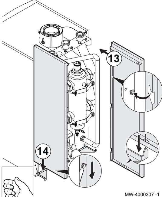
13. Remonter les deux panneaux latéraux du kit de la bouteille de découplage.
