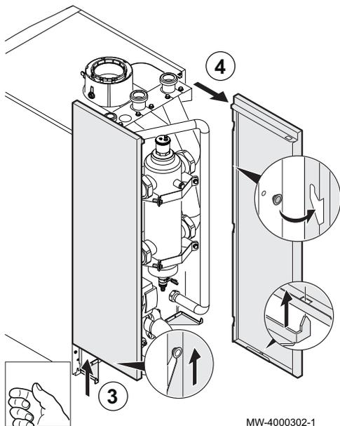
3. Soulever les deux panneaux latéraux du kit de la bouteille de découplage.
