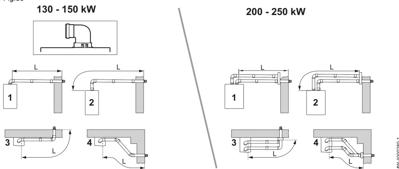
Tab.30 Longueur maximale pour la configuration C<sub>13</sub>
