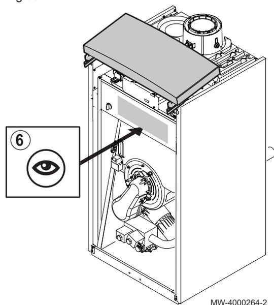
6. **Uniquement pour les IX 245–130 et IX 245–150** : démonter le panneau amovible si nécessaire.
