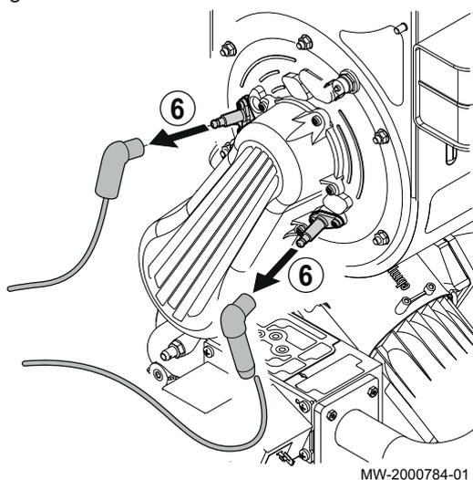
6. Débrancher l'électrode d'allumage et la sonde de détection de la flamme.
