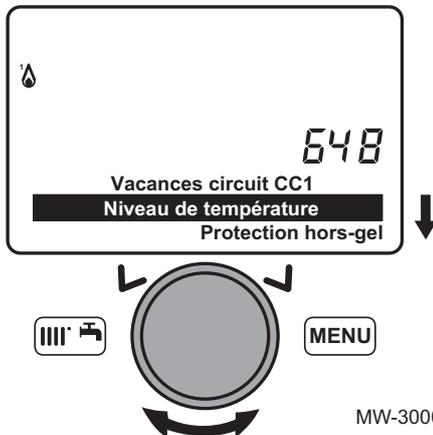
14. Sélectionner le paramètre **Niveau de température** en tournant le bouton (⌚).
