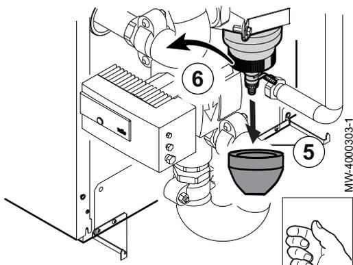
5. Démontez la coque inférieur de l'isolant.
