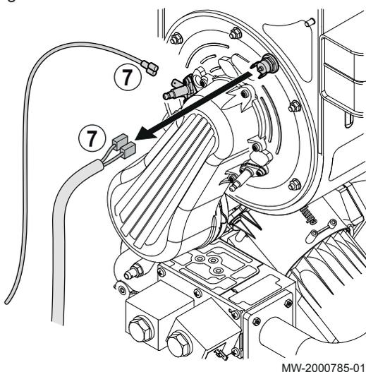
7. Débrancher les 2 fils du thermostat de sécurité de la porte foyer et la cosse sous l'électrode d'allumage.
