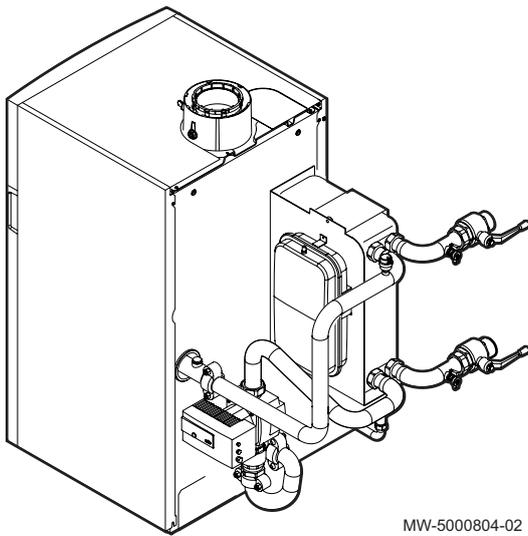
Un échangeur à plaques a pour avantage principal d'isoler hydrauliquement les circuits primaire et secondaire. Il permet ainsi de protéger le corps de la chaudière contre les impuretés présentes dans l'eau du circuit de chauffage secondaire.
