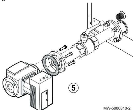
5. Monter le circulateur sur la conduite du retour chauffage (circulateur non fourni).
