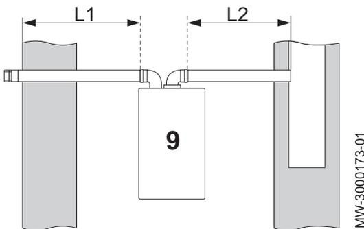
Tab.32 Longueur maximale pour la configuration C<sub>53</sub>
