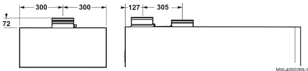
Ce type de conduits permet d'évacuer les gaz brûlés et d'aspirer l'air comburant aussi bien à l'extérieur de l'édifice que dans des conduits de fumées. Le coude coaxial à 90° permet de raccorder la chaudière aux conduits d'évacuation-aspiration en toutes directions grâce à la possibilité de rotation à 360°. Il peut également être utilisé comme coude supplémentaire en association avec le conduit coaxial ou le coude à 45°.
