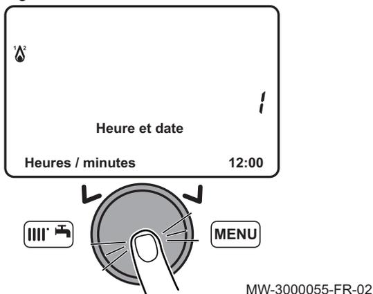
4. Valider la sélection du paramètre en appuyant sur le bouton **(▶)**.
