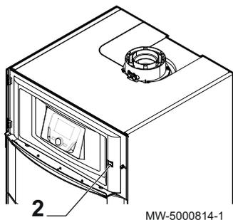
2. Démarrer la chaudière en appuyant sur l'interrupteur Marche/Arrêt.
